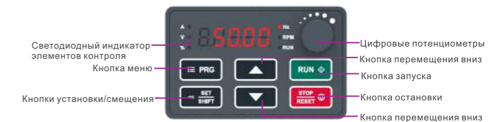
Одиночная внешняя клавиатура (размер отверстия для одной клавиатуры: 60*36 мм)
