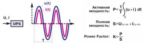
В технических характеристиках любого ИБП указаны **полная мощность** [кВА] и **активная мощность** [кВт] — они характеризуют нагрузочную способность устройства (например, ИБП). Пример, см. фотографии ниже:
