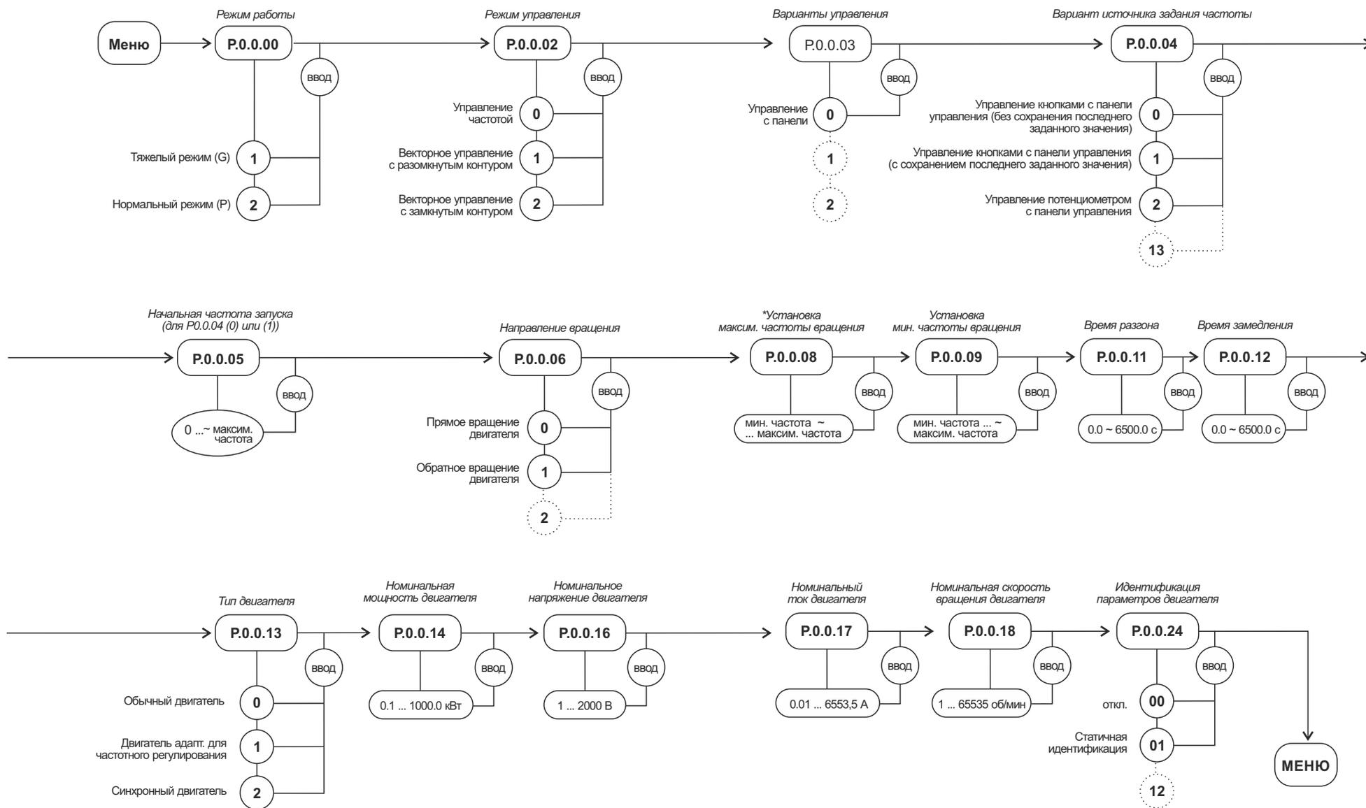
\* Верхний предел для параметра P0.0.08 устанавливается параметром P0.0.07
